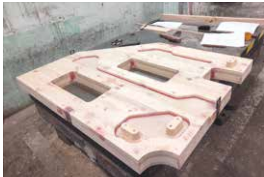
Minden öntvényalkatrész életútja a famintakészítéssel kezdődik
