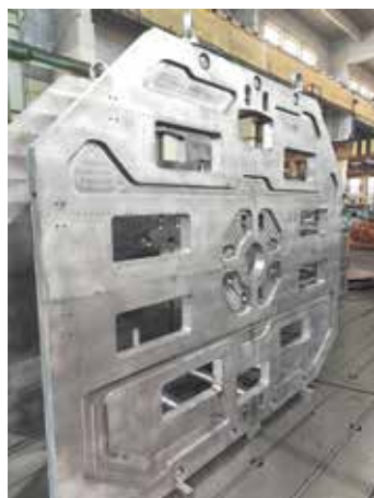
A 8 lapból álló gépváz teljes súlya 6500 kg. 1db öntvénylap méretei: 1450 x 1200 x 80 mm, súlya 1060 kg
